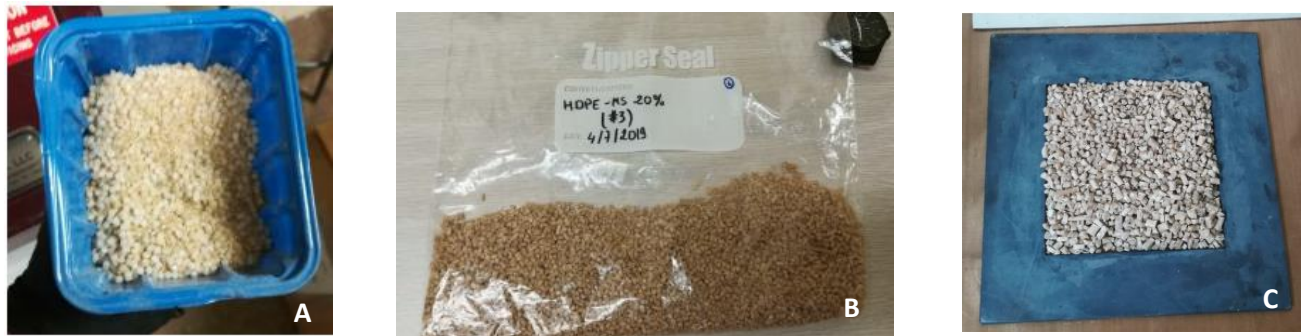
Figure 34. Granulations des fibres avec HDPE (A, B) et le moulage des plaques (C).
