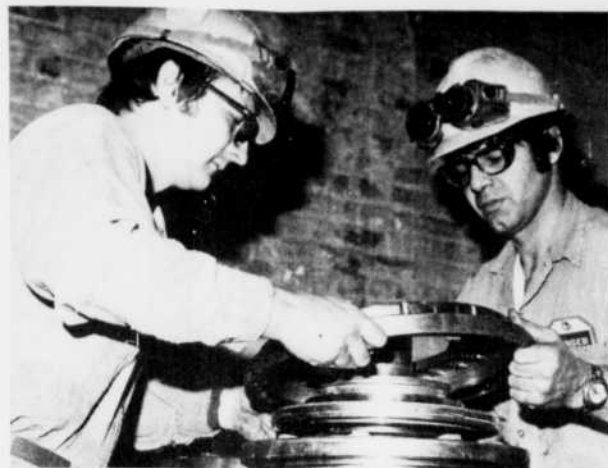
A L'ATELIER DE MONTAGE - MM. André Simard et Mivil Fortin monteurs de machinerie à l'usine de minerai no 1, Usine Vaudreuil, procèdent ici au montage de pièces de centrifuges qu'ils manipulent avec autant de soin que le font les employés de l'atelier d'usinage.
