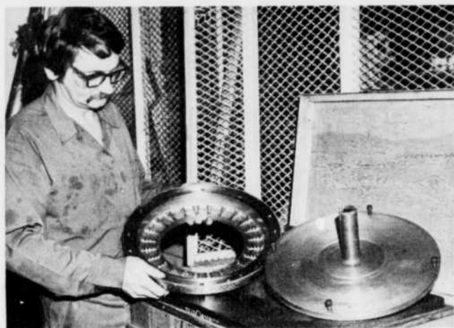
M. Camille Dahl, machiniste de l'atelier d'usinage, illustre ici une pièce de centrifuge en acier inoxydable qu'il lui est donné d'usiner et une autre pièce que l'atelier a fabriquée pour permettre de balancer celle qu'il tient dans ses mains. M. Dahl est un machiniste de 12 années de service.
