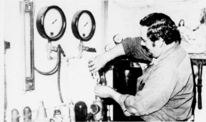
DE TOUTES LES GROSSEURS ET DE TOUTES LES CAPACITES - Grâce à l'appareillage de vérification à l'azote [nitrogen], les valves hydrauliques sont vérifiées en grande quantité. M. Roland Gaudreault est ici à l'oeuvre devant un étalage de valves en provenance de tous les départements des usines d'Arvida.
