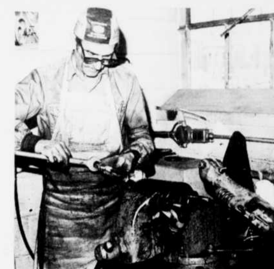
M. WELLIE DUFOUR du secteur "pneumatique" de l'atelier d'usinage et d'ajustage procède à une réparation d'un marteau pilon tels ceux qui sont utilisés par centaines dans les usines. Il travaille dans une pièce insonorisée qui lui permet de vérifier les marteaux ou autres pièces sans incommoder les autres travailleurs dans l'immeuble.
