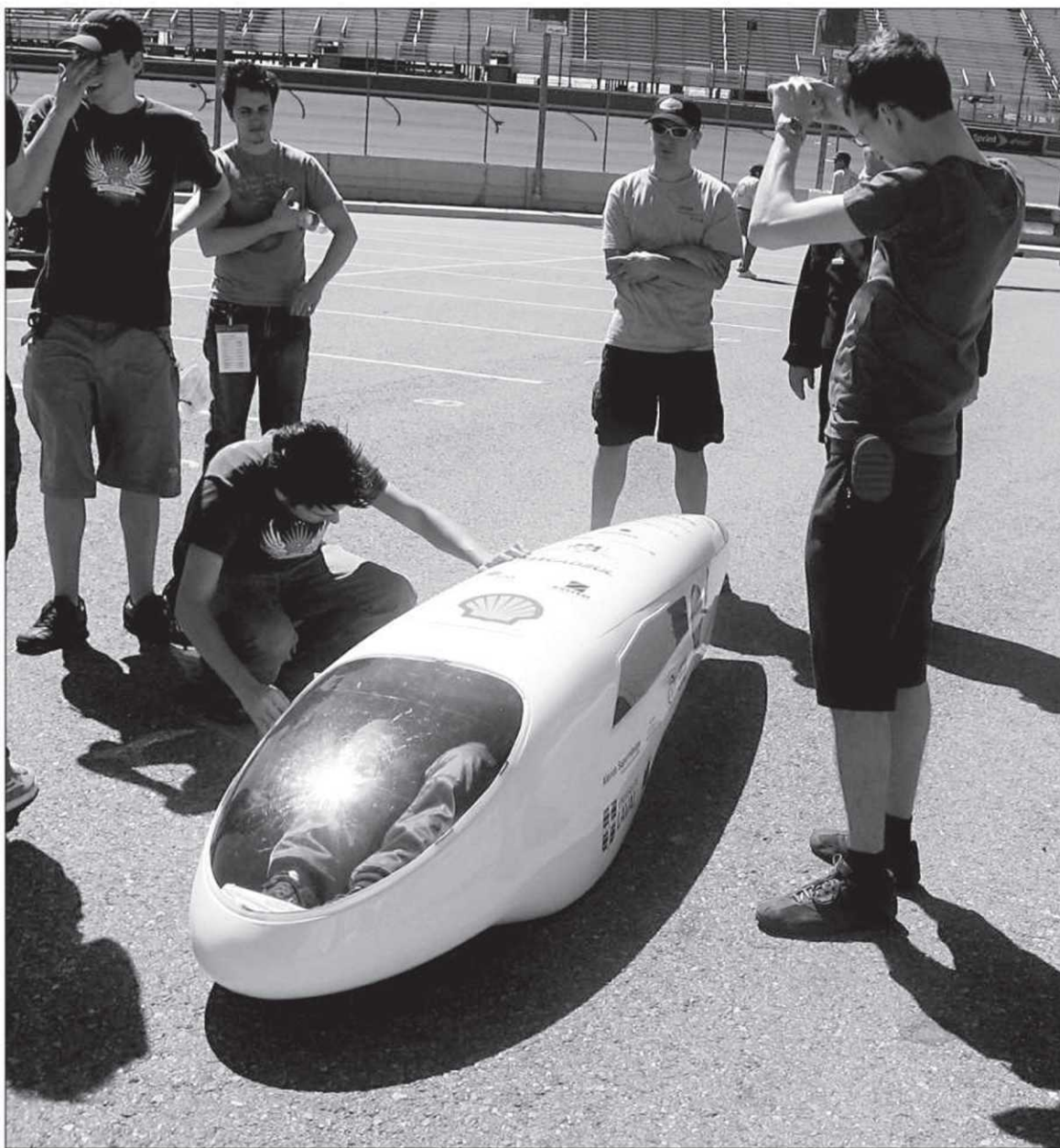
Le roulement et l'aérodynamique étaient très importants car pour économiser du carburant, les conducteurs éteignent leur moteur le plus souvent possible, pour profiter au maximum de leur erre d'aller.
