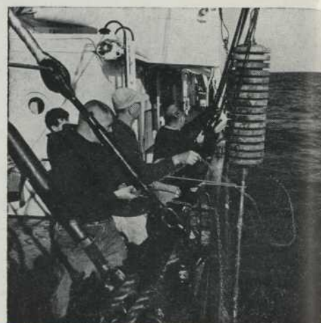
On se prépare à immerger l'appareil qui prendra des échantillons de sédiments au fond de la mer.
