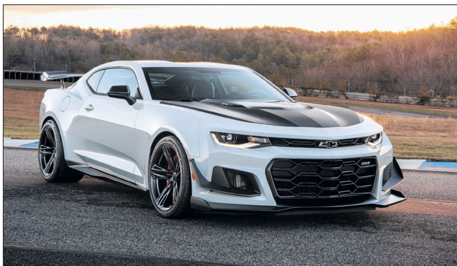
La Chevrolet Camaro ZL1 1LE est équipée d'un V8 suralimenté de 6,2 l et 650 ch, de pneus Goodyear F1 Supercar 3R, de déflecteurs d'air et d'une suspension de course.
