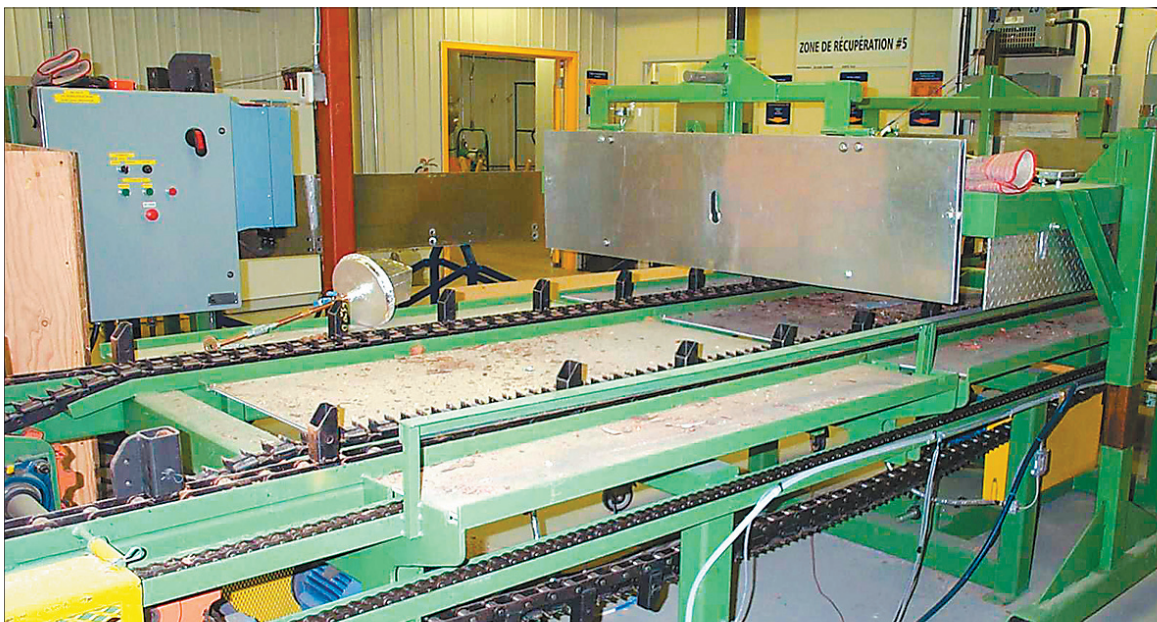
Le dégel des billes par rayonnement infrarouge avant écorçage; un moyen développé dans le cadre du programme Électrobois, en collaboration avec le LTE et FPInnovation, division Forintek. Ce système permet de réduire les coûts rattachés à l'écorçage pendant la période hivernale.
