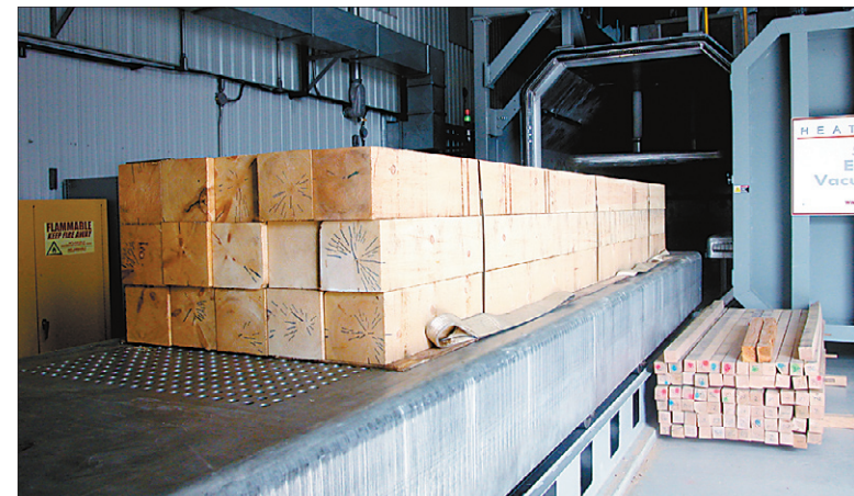
Séchoir haute fréquence sous vide pour le séchage des pièces massives.
