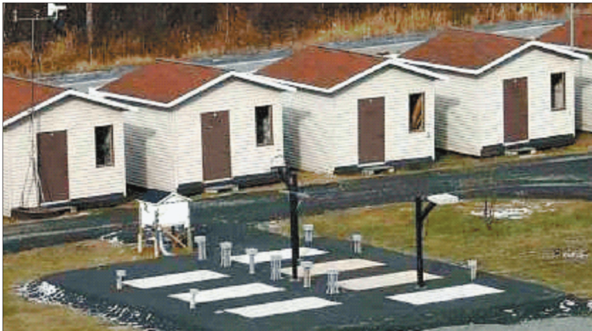
Les travaux de l'équipe du LTE de Shawinigan profitent à tous, incluant au grand public. Ici, des maisonnettes peuvent abriter différents bancs d'essai, en reproduisant les conditions des habitations traditionnelles.
