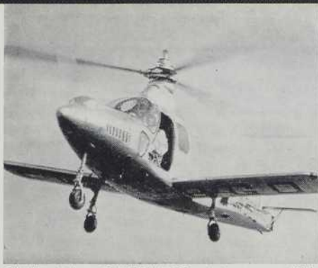
L'hélicoptère FARFADET, type convertible avec plans fixes réduits et réacteur indépendant du rotor.
