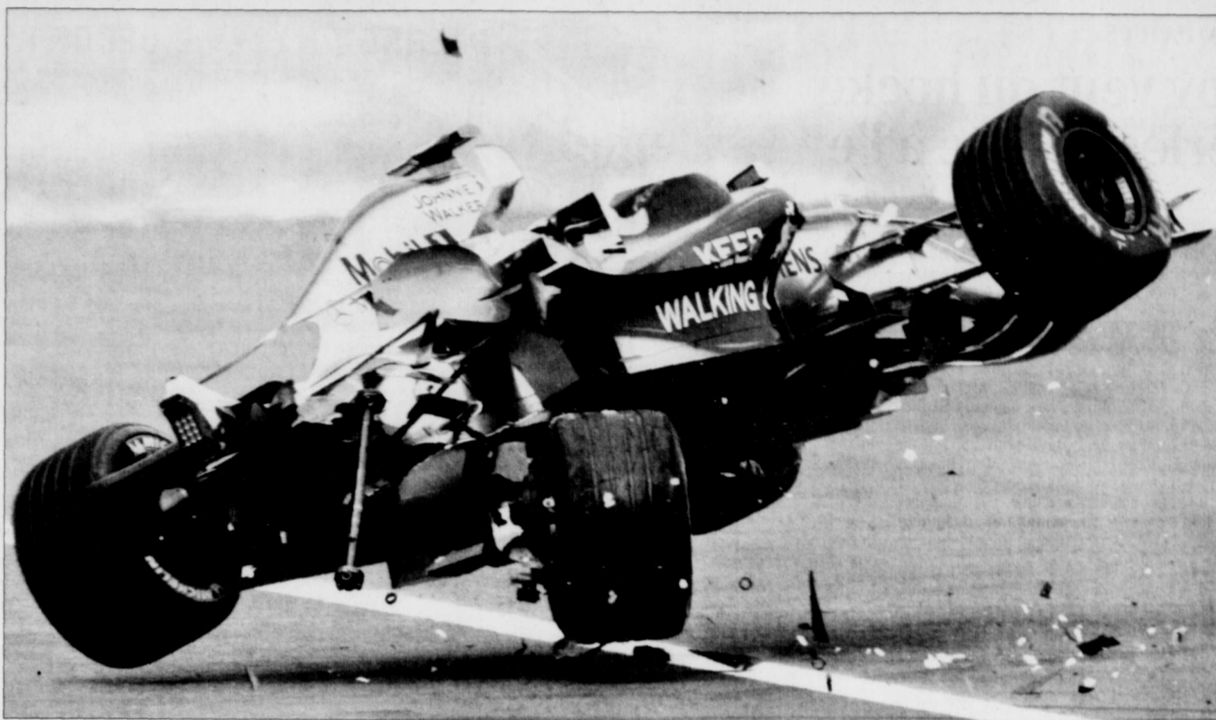
À la suite du bris d'un triangle de suspension, tout le train arrière droit de la MP4-21 de Kimi Räikkönen s'est arraché et l'aile arrière, peinte aux couleurs d'une compagnie aérienne, s'est envolé. Incontrôlable, la McLaren-Mercedes est partie en toupie et a même failli se retourner lorsqu'elle a rebondi sur la roue arrière droite qui pendait, retenue par un câble de sécurité. Il a pu rentrer au stand sur les trois roues restantes, mais n'ayant pu établir de chrono lors de cette première phase des qualifications, il s'élancera de la dernière position aujourd'hui. «Je suis vraiment déçu, car je pense que l'équipe a une bonne stratégie et que j'aurais pu être parmi les plus rapides.»
