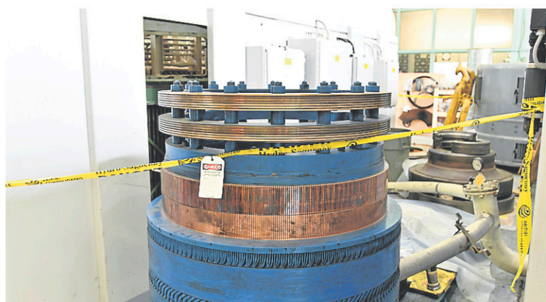
L'excitatrice dynamique laissera sa place à une excitatrice statique. — PHOTO LE QUOTIDIEN, MICHEL TREMBLAY
