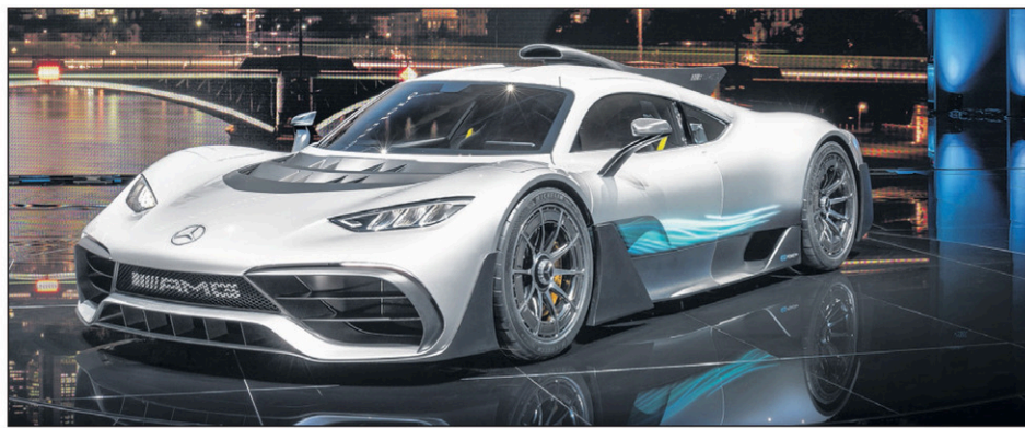
La Mercedes-Benz Project One utilise des technologies de la F1. Le petit V6 suralimenté de 1,6 l fonctionne avec quatre moteurs électriques pour une puissance de 1000 ch.
