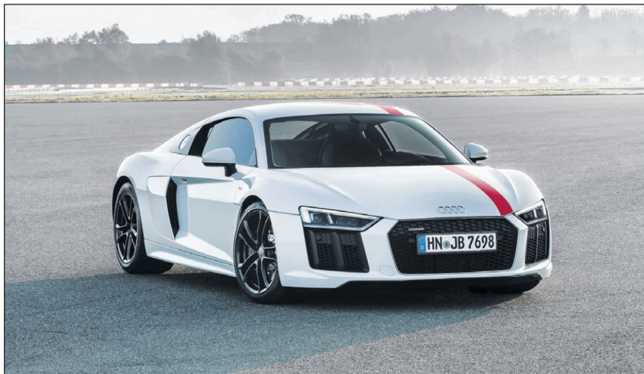
L'Audi R8 V10 RWS abandonne la traction intégrale quattro pour devenir une propulsion (roues arrière motrices). Le moteur développe 540 ch.
