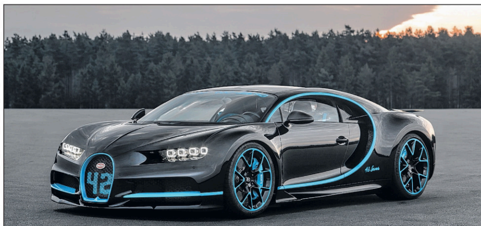
Bugatti a dévoilé la Chiron 42 qui accélère de 0 à 400 km/h et freine ensuite de 400 à 0 km/h en 42 secondes. Le moteur est un W16 quadri-turbo de 8,0 l et 1500 ch.
