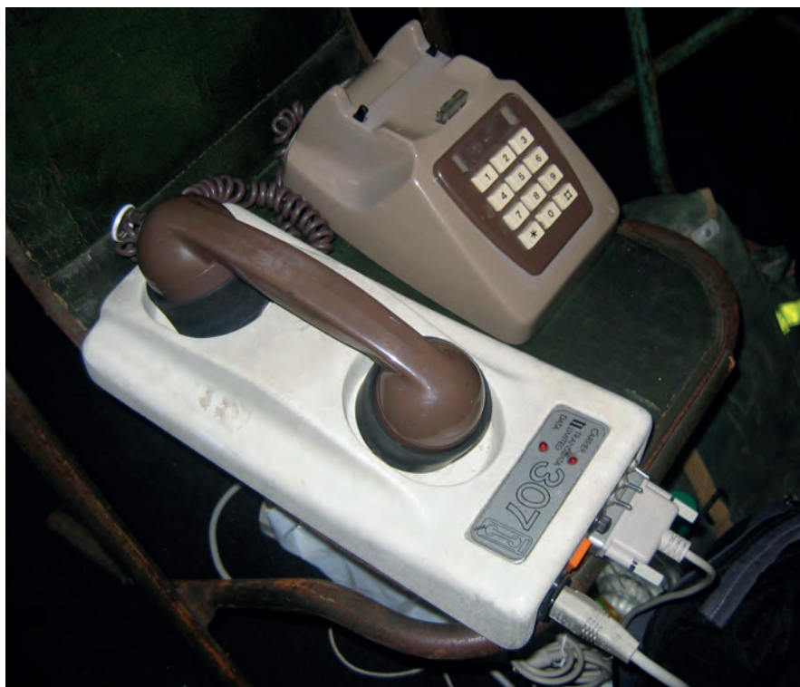
Avant la distribution d'Internet par les réseaux locaux, l'accès se faisait au moyen d'un modem acoustique branché sur un port série à un réseau analogique comme une ligne téléphonique.
