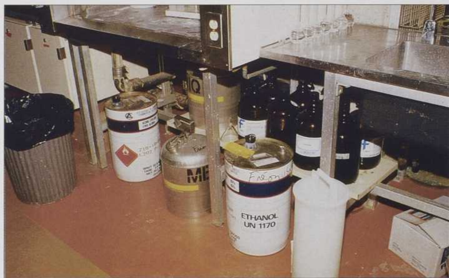
Au Complexe scientifique du Québec, en 18 ans, le nombre d'employés est passé de 300 à 800. L'état d'encombrement entraîné par le réaménagement de l'espace de laboratoire se traduit, entre autres, par l'entreposage non sécuritaire des produits.
