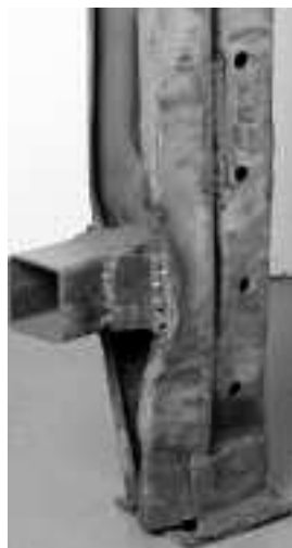
Figure 54. Montant double endommagé: soudure non conforme, usure et déformation du montant causées par le frottement des longerons du chariot élévateur (Photo : Maurice Vézinét)
