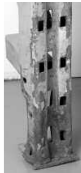
Figure 55. Montant en acier corrodé, usé par frottement et ressoudé (Photo : Maurice Vézinét)
