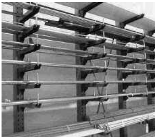
Figure 11b. Râteliers en porte-à-faux pour charges légères munis de butoirs aux extrémités des bras (Photo : Technirack)
