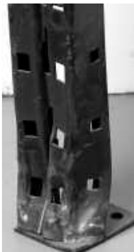
Figure 53. Montant endommagé: la soudure à la hauteur de la plaque de pied d'échelle a cédé (Photo : Maurice Vézinét)
