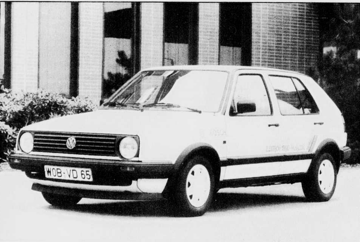
La Golf hybride possède un moteur diesel ainsi qu'un moteur électrique, ce qui réduit la consommation totale de carburant de plus de 60%.
