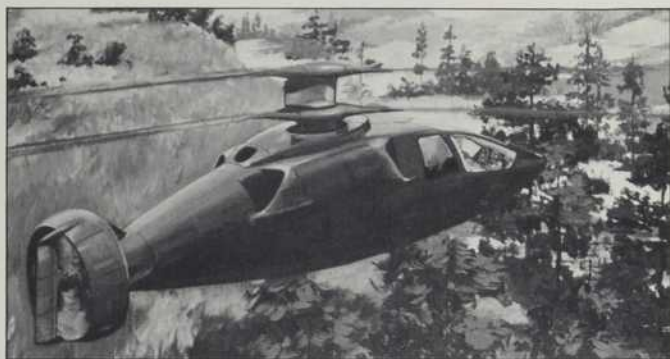
Le modèle SEMA-X de Sikorsky. Son rotor de queue avec fenestron permettrait de fortes accélérations et décélérations.
