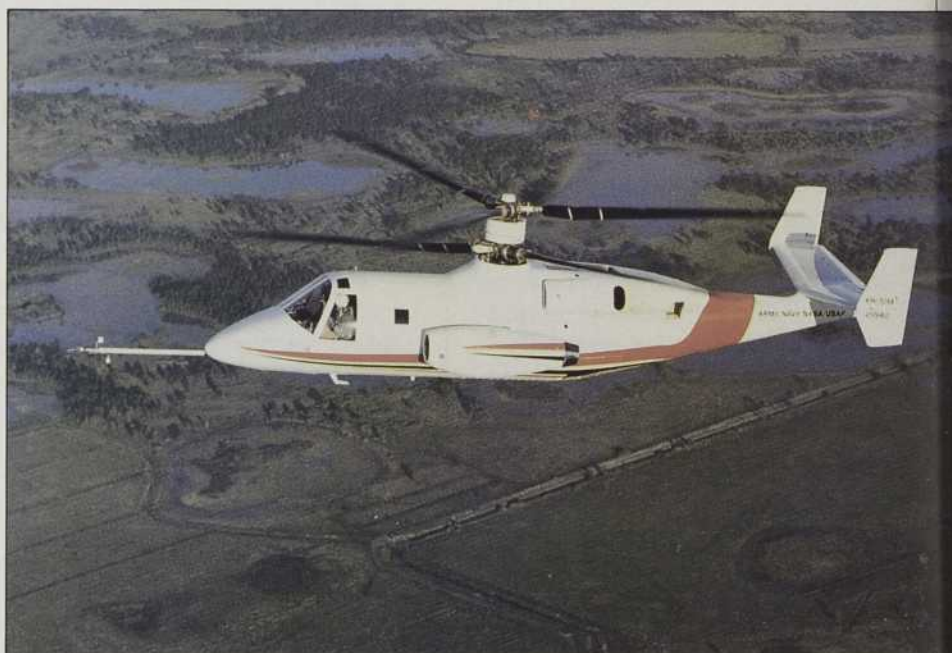
Ce prototype XH-59A du ABC a atteint la vitesse de 487 km/h lors des essais. On remarque les deux rotors tournant en sens contraire l'un par rapport à l'autre.
