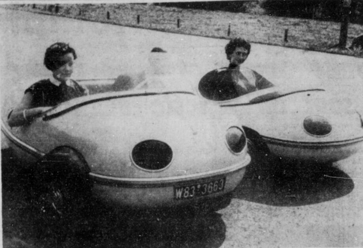
CETTE PHOTO nous montre la dernière invention de l'automobile allemande. C'est une petite voiture à 3 roues inventée par Egon Bruetsch, de Stuttgart, Allemagne. L'auto pèse 370 livres, n'a qu'un cylindre et peut rouler jusqu'à 60 milles à l'heure. Le coût en est d'environ $490. Deux modèles, un pour une personne et un autre pour deux, ont été construits.
