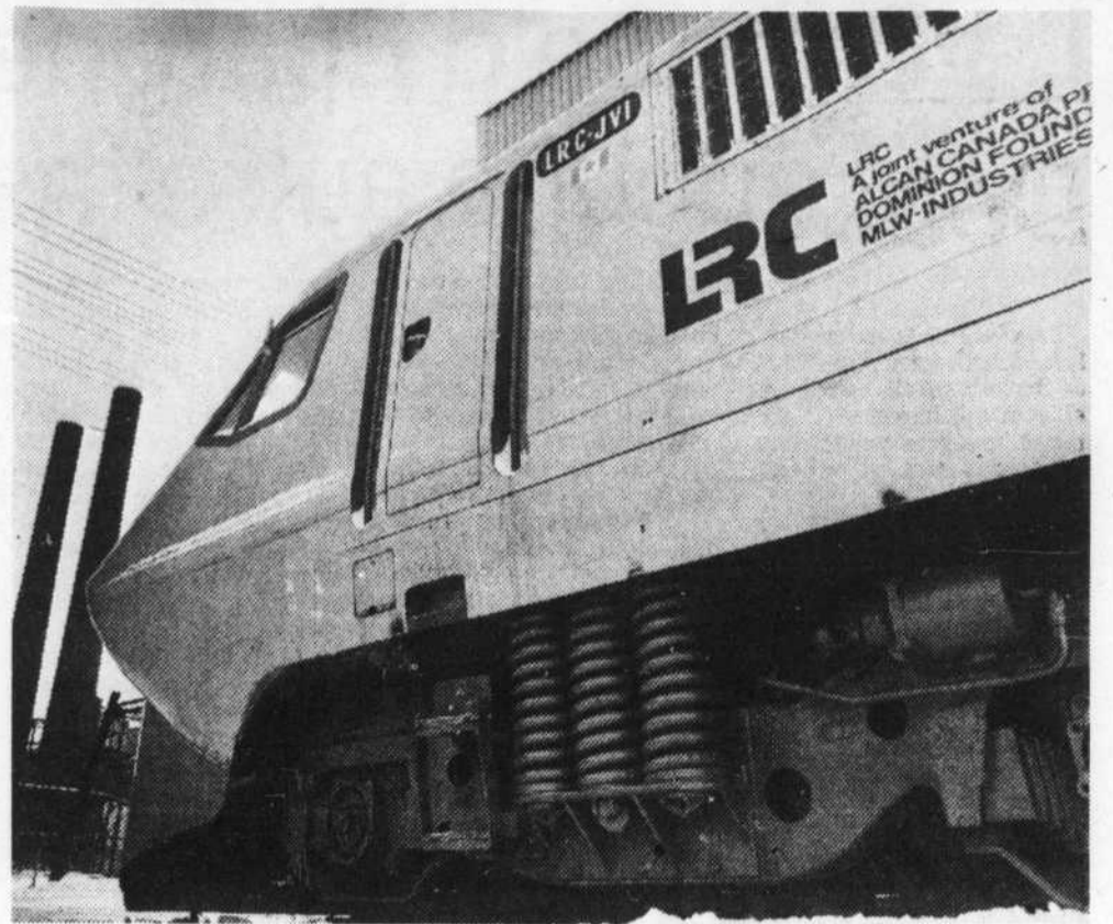
Le prototype du train LRC de Bombardier-MLW qui a effectué des essais sur 150,000 milles et battu, entre Montréal et Québec, le record canadien de vitesse sur rail avec une pointe de 129 milles à l'heure. Sa consommation... un mille au gallon!
