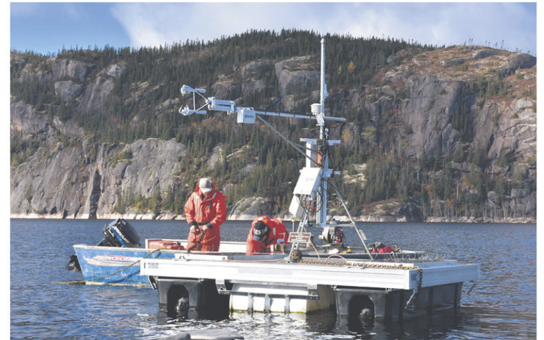
INSTALLATION MESURANT L'ÉVAPORATION SUR LE RÉSERVOIR DE LA ROMAINE 2
