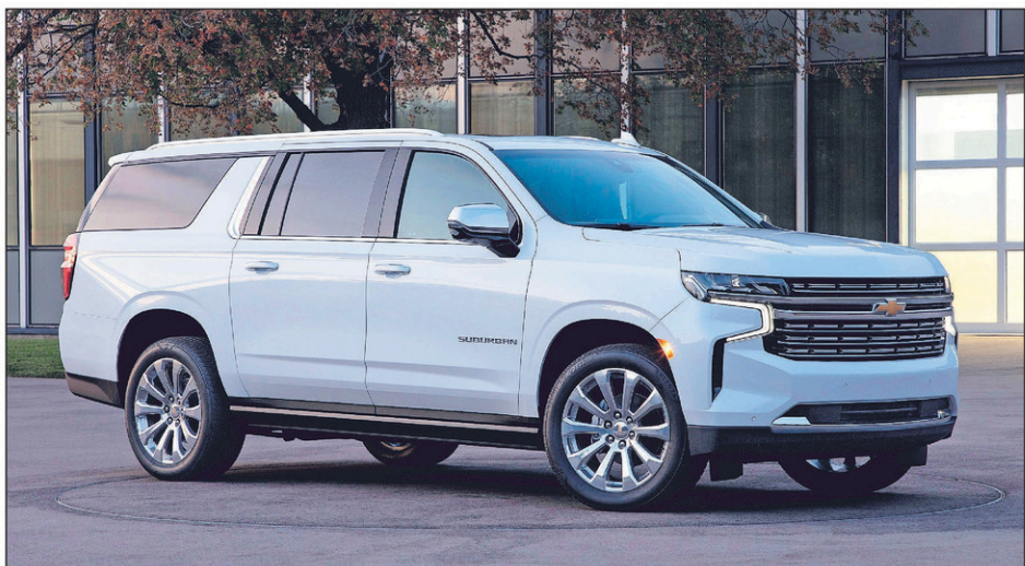
Le Chevrolet Suburban et le Tahoe sont propulsés par un V8 de 5,3 l, un V8 de 6,2 l ou un V6 turbodiesel de 3,0 l; le tout est associé à une boîte à 10 rapports.
