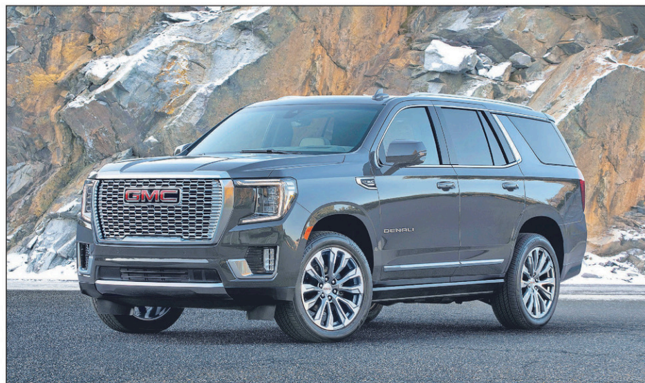
Le GMC Yukon 2021 repose sur une plateforme monocoque et une suspension arrière indépendante. L'espace intérieur a été agrandi pour les passagers et les bagages.
