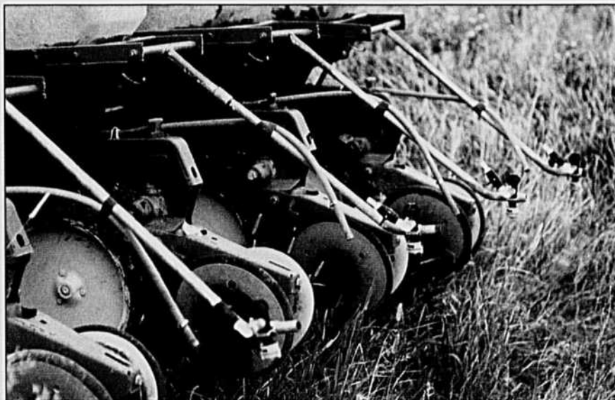
L'équipement d'arrosage en bandes peut être monté sur le semoir ou sur le sarcloir (photo Roger Fontaine)
