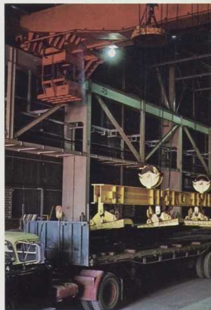
Ayant subi toutes les épreuves de contrôle de la qualité, la tôle est expédiée au client, taillée aux dimensions requises ou découpée selon ses exigences.
