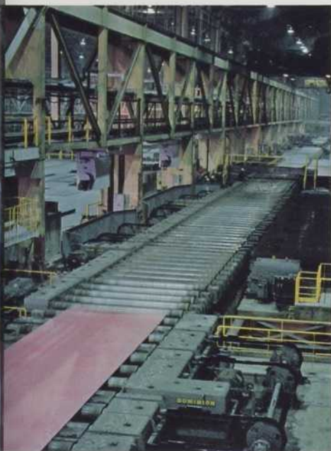
Laminées en épaisseurs et en largeurs précises, selon l'usage auquel elles sont destinées, les tôles quittent le train de laminage par les tables de sortie.
