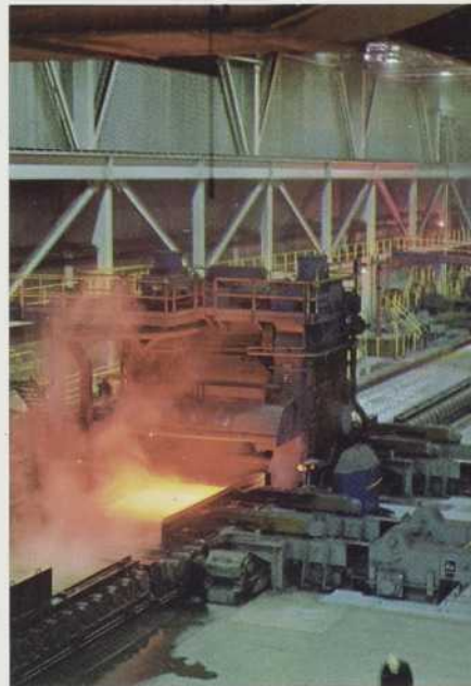
Le laminoir à tôles fortes, le plus moderne et le plus large du Canada, peut produire des tôles de 140" de large et de 3/16" à 6" d'épaisseur.
