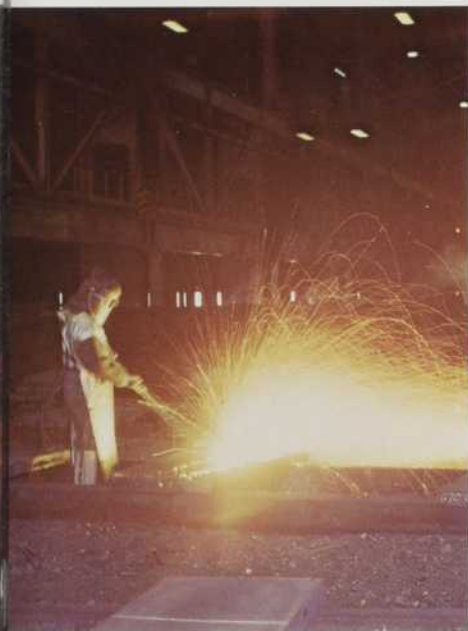
Les brames d'acier provenant du laminoir à blooms sont inspectées et débarrassées de leurs défauts superficiels, avant d'être laminées en tôles.
