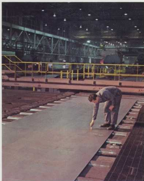
Après un passage dans la machine à redresser, la tôle est minutieusement inspectée.
