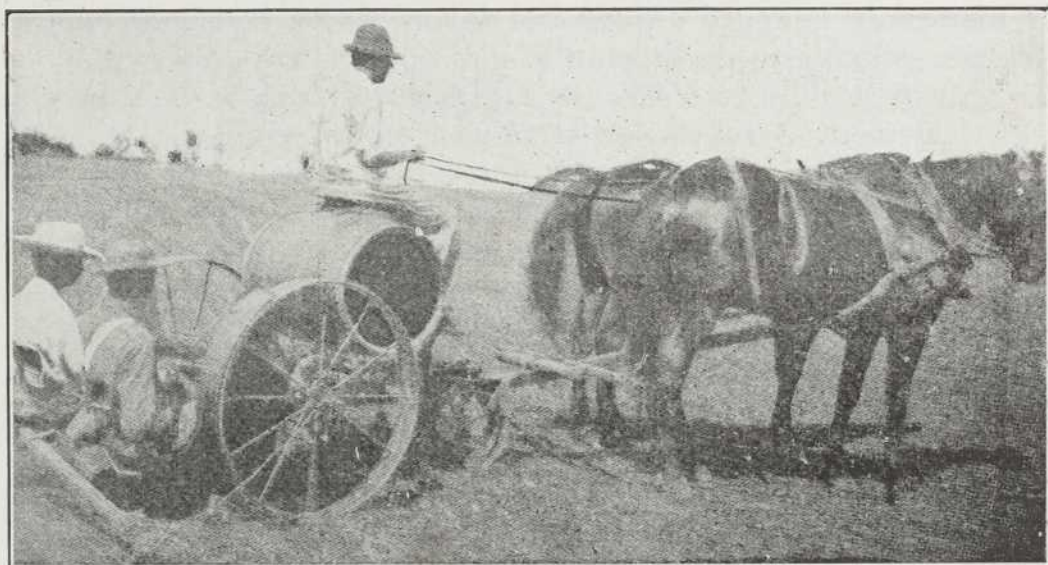
Fig. 11—La machine à transplanter le tabac.
