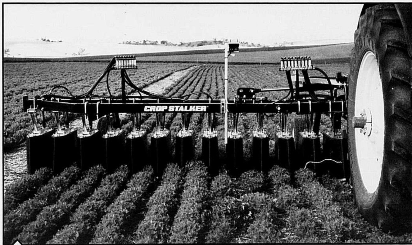
Une enveloppe rigide de 23 cm de largeur recouvre l'entre-rangs. Sous l'enveloppe, le jet de la buse est dirigé au sol sur les mauvaises herbes.
