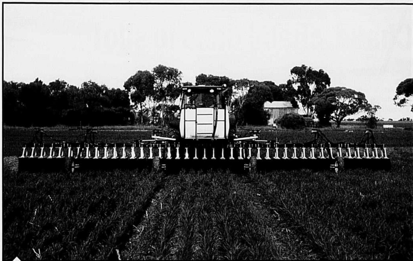
Le CropStalker permet l'application d'herbicides dans l'entre-rangs.
