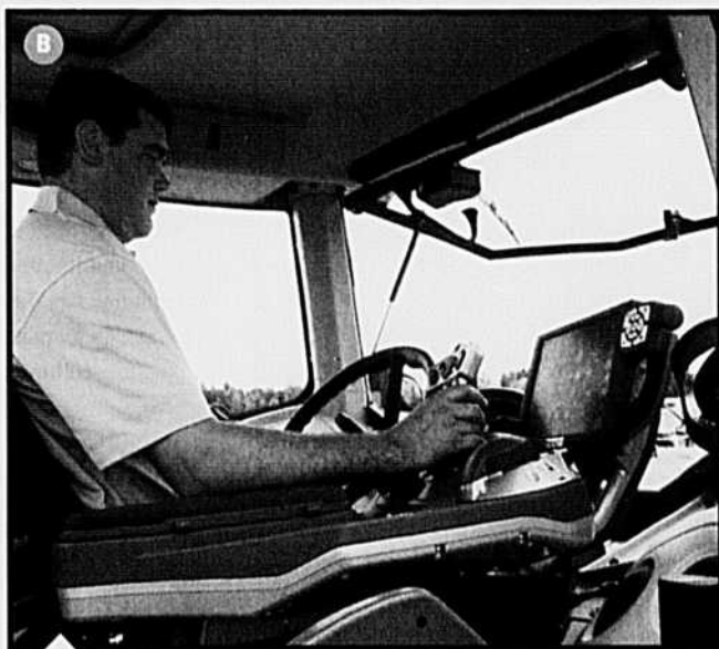
Le poste de conduite des Fendt s'oriente en quelques secondes de l'avant (photo A) vers l'arrière du tracteur (photo B).
