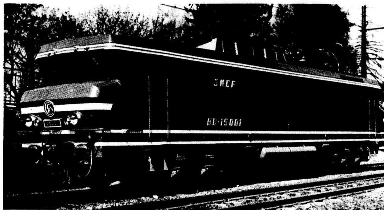
Une des plus récentes locomotives électriques: la BB 15.000 utilisée sur la ligne Paris-Strasbourg.
