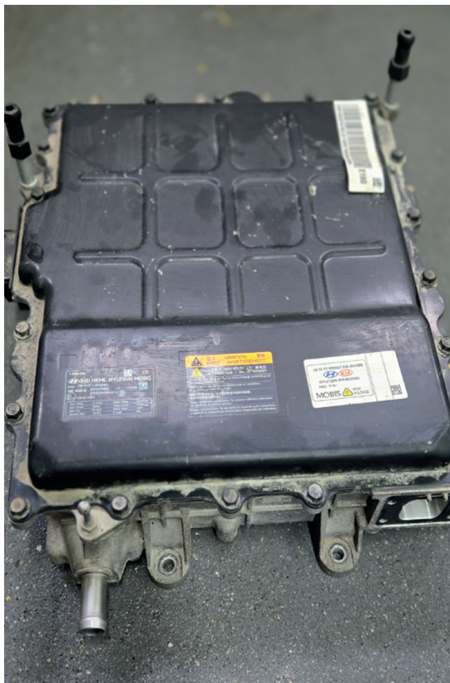
Le chargeur embarqué de la Niro qui demandait un remplacement.
