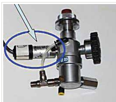
Capteur de pression
