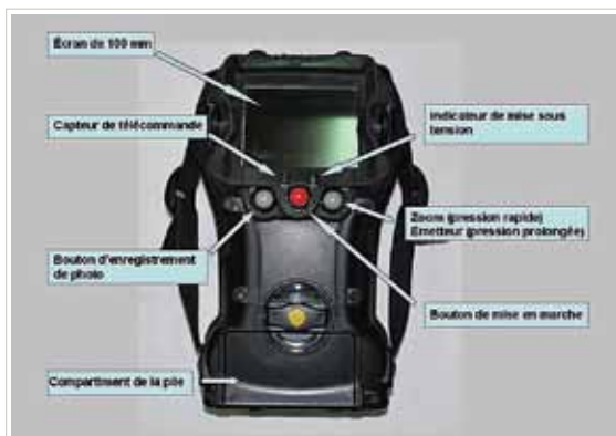
Caméra à imagerie thermique
