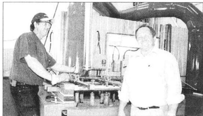
INAUGURATION - Réjean Michaud, président de Jointes et hydraulique du Saguenay, et l'opérateur, Yves Gagné, sortent d'un bassin d'acide chromé un cylindre qui a retrouvé son apparence d'origine.
