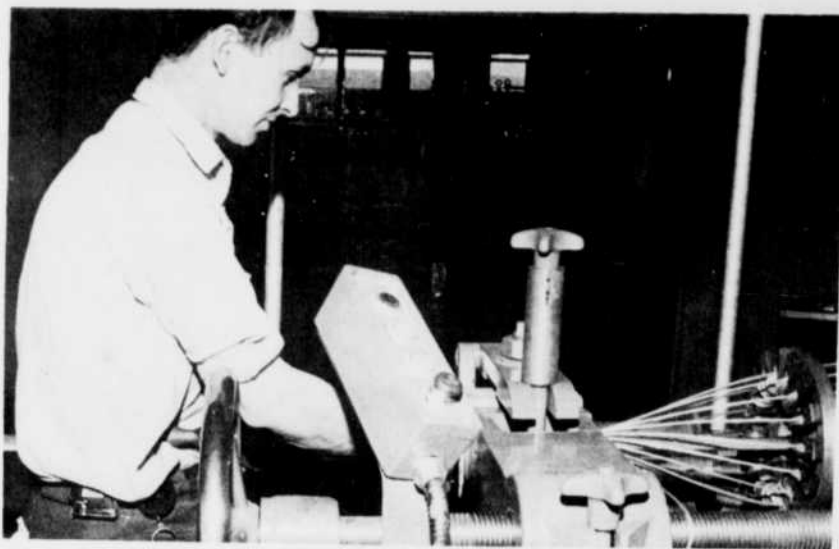
UN CABLE de type "Drake" sort d'une toronneuse à bâti rigide pour le toronnage des fils d'aluminium. Ce câble est produit pour la Commission hydro-électrique de Terre-Neuve et du Labrador.
