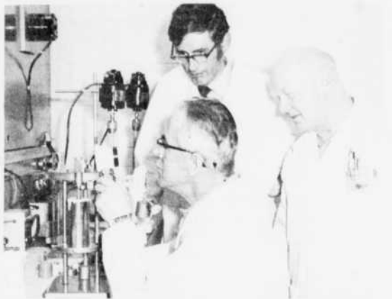
LE COMPORTEMENT — Autour de M. Ovila Cossette, analyste, MM. Michael Roberts, céramiste et R. Hallahan, analyste attendent le résultat de l'étude en cours, celle de la rhéologie et du comportement des alumines spéciales. Ils mesurent la viscosité de l'alumine en suspension au moyen d'un viscosimètre "Stormer". Ces employés sont de la division de la céramique à Recherche et Développement de l'Alcan, Ltée.
