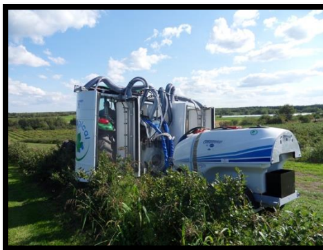
Figure 10.9 Pulvérisateur à jet porté muni d'un tunnel de pulvérisation
