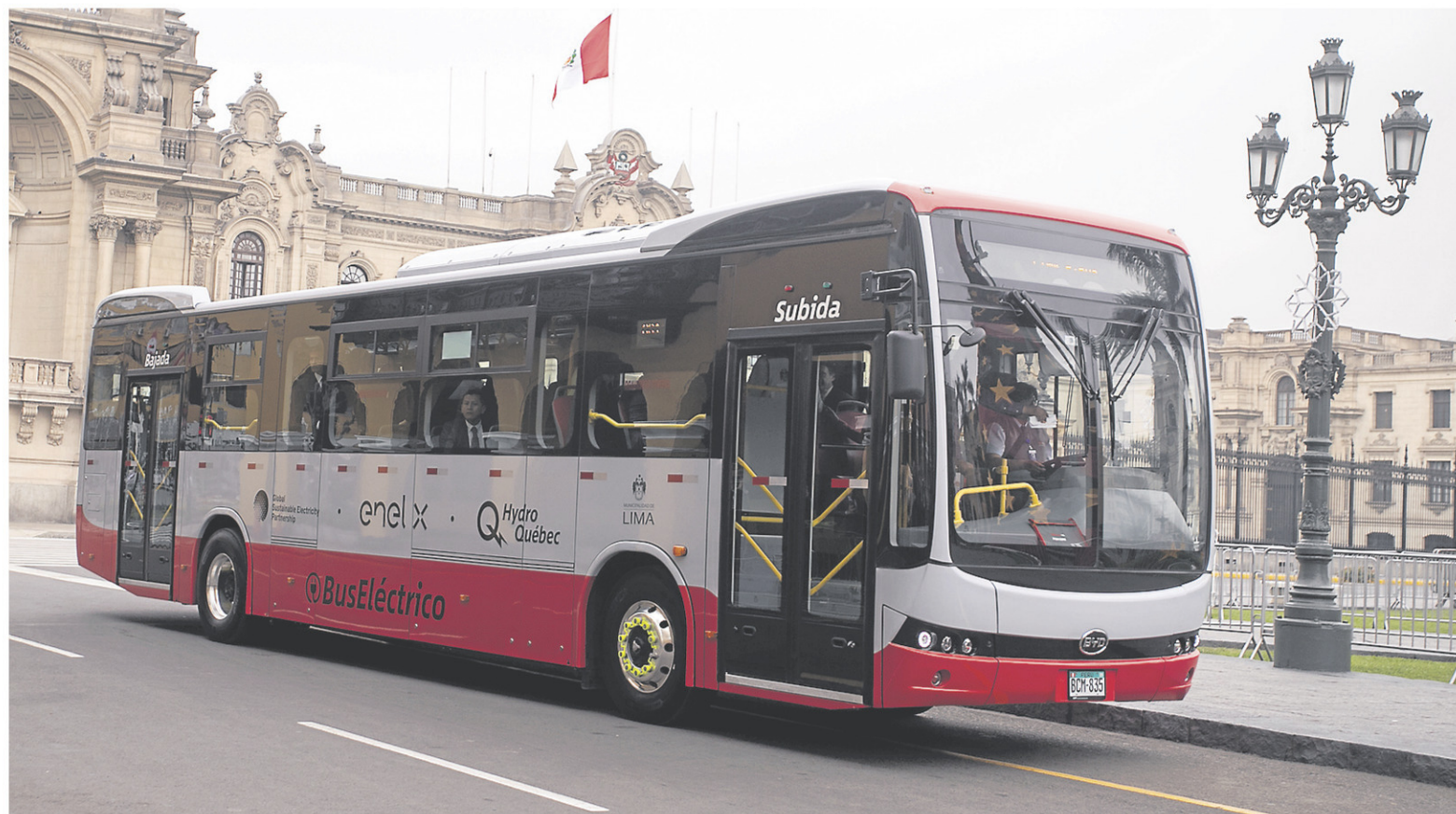
Cet autobus électrique de 80 passagers sera exploité par Allin Group, l'un des exploitants locaux de Protransporte, sur la ligne Corredor Rojo, l'une des artères les plus fréquentées de Lima. Sa batterie pourra être rechargée en quatre heures pour 150 km d'autonomie. — PHOTO FOURNIE PAR HYDRO-QUÉBEC
