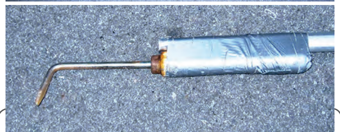
Filet de dérive et pic pour gratter les pierres collées du fond du ruisseau. Vue en gros plan du pic pour gratter les fonds où les pierres sont collées dans le fond.
