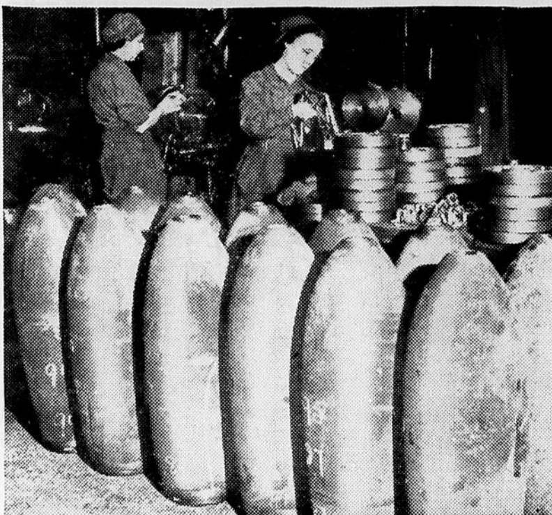
La production industrielle britannique, monte chaque mois, grâce à l'accélération du programme et à l'apport des nouvelles usines. On voit ici des ouvrières anglaises construisant des fusées destinées aux grosses bombes de 500 livres.
