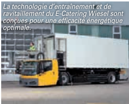
Grâce à sa cabine coulissante, le E-Catering Wiesel peut si nécessaire descendre au niveau du sol pour faciliter les opérations de manutention.
