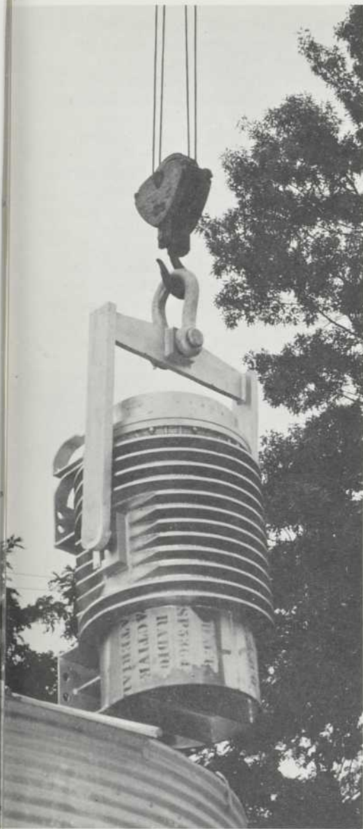
Mise en place d'une source de cobalt 60 pour irradier les monomères plastiques dont le bois est imprégné.
