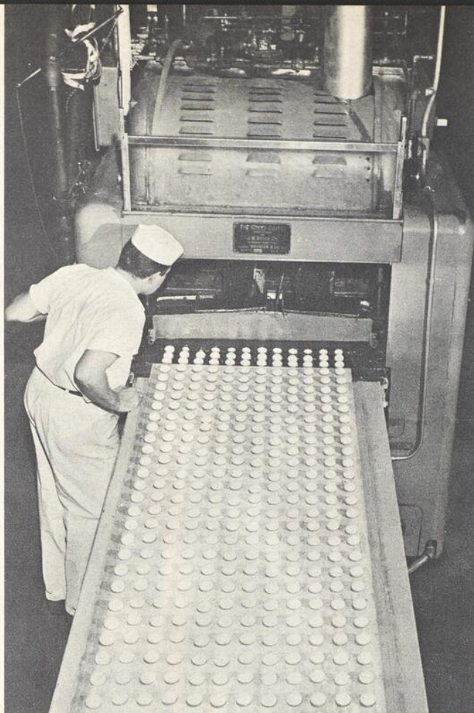
Les biscuits passent sous un rideau de chocolat liquide qui les enrobe.
