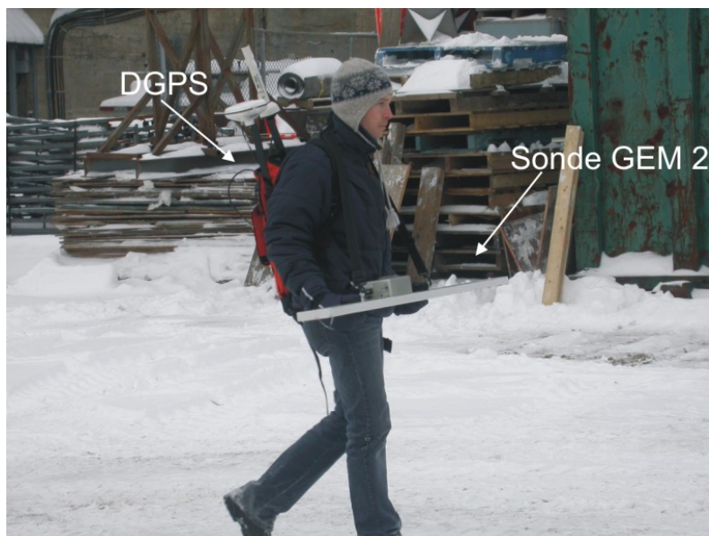
Figure 7. La sonde d'induction électromagnétique GEM-2 multifréquences couplée à un système de positionnement DGPS sub-métrique (photo : quai de la Garde côtière du Canada, Port de Québec). Opérateur : Yves Monette.
