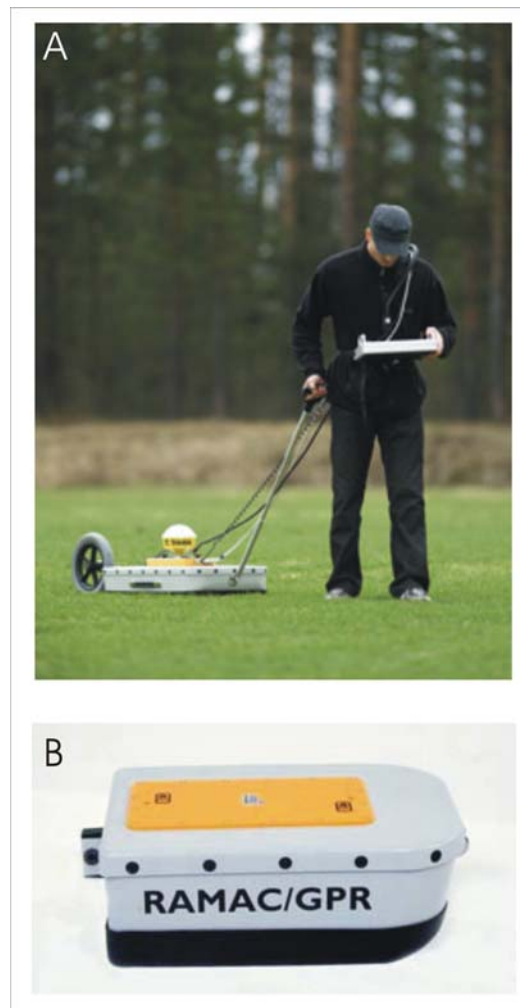
Figure 9. Système Géoradar RAMAC de la compagnie Mala . Le système comporte une antenne blindée, une roue de précision (évaluation des distances) ainsi qu'un moniteur permettant de visualiser les spectres radar en temps réel.
