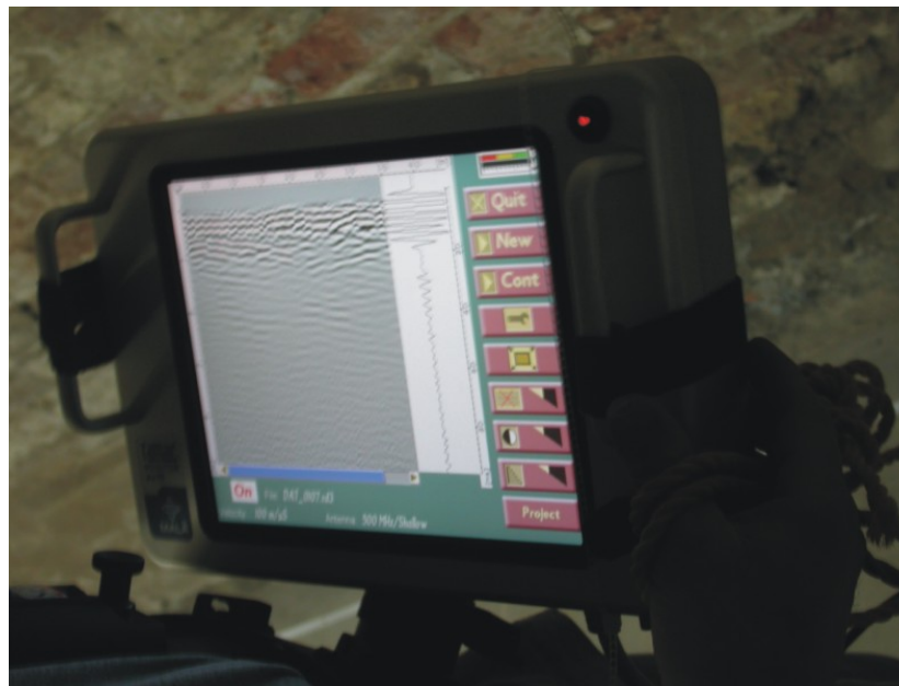
Figure 10. Géoradar RAMAC X3M de la compagnie MALA (Suède) composé d'une antenne blindée de 500 MHz et de son moniteur permettant une visualisation des acquisitions en temps réel.
