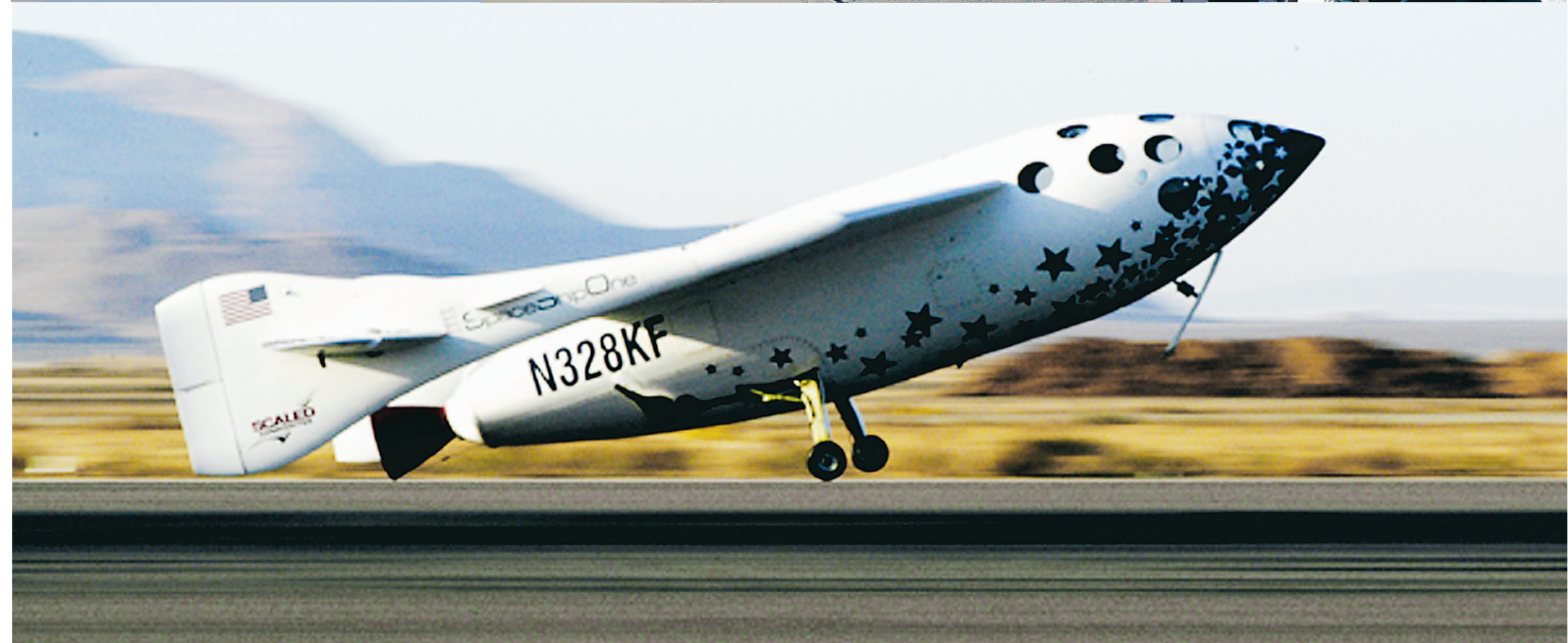
SpaceShipOne en train d'atterrir à l'aéroport de Mojave, en Californie, à la fin d'un vol d'essai qui a eu lieu le 13 mai. En haut, trois photos de White Knight, l'avion porteur qui doit amener SS1 au palier des 15 000 m avant de le laisser se propulser jusqu'à l'altitude des 100 000 m. SS1 doit par la suite revenir au sol en planant.
