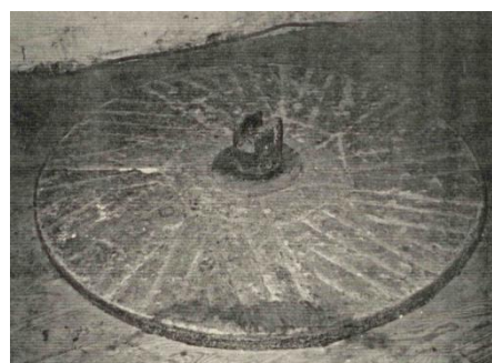
meule tournante du moulin Guémançais {photo Aimé Gagné 1986}
