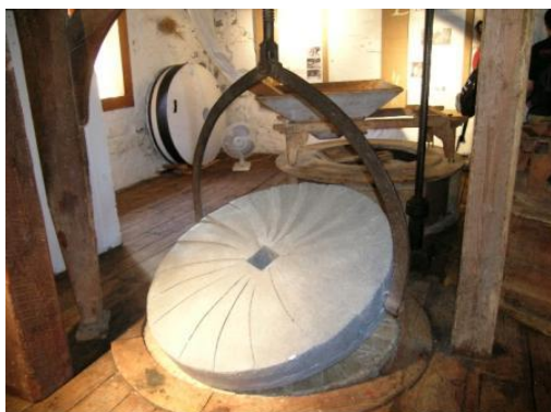
Au dernier étage du moulin se trouvent les meules qu'on déplace à partir d'une potence solide, agrippée à un epince d'acier courbée.
