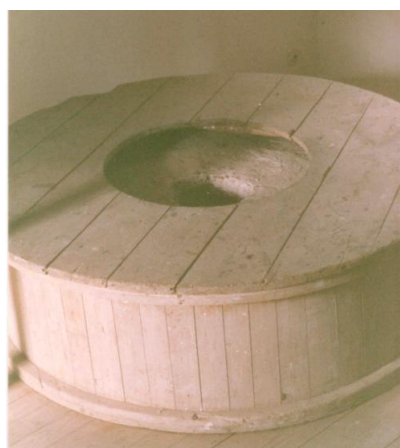
Meule gisante avec son boîtier. {photo Aimé Gagné 1986}
