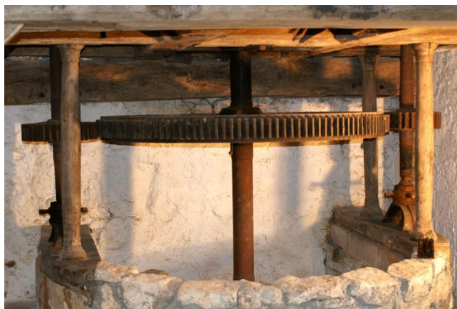
Puits de pierre contenant le mécanisme primaire du moulin 2- Grande roue située sur l'axe central émergeant du puits {photo droite Aimé Gagné 1986, photo gauche Nina Kveseladse 2013}
