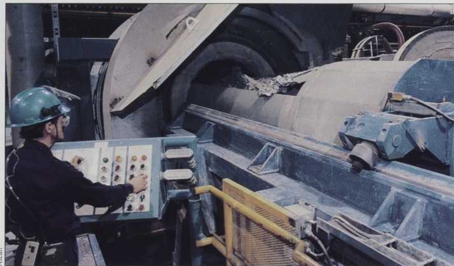
À l'usine Guillaume-Tremblay, l'aluminium contenu dans l'écume, sorte de résidu gris et spongieux, est récupéré presque en totalité.
