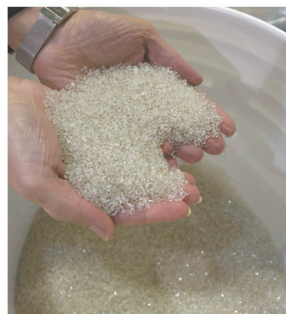
Après avoir été liquéfié dans l'huile, le polystyrène est extrait et concentré sous forme de granules pour être réutilisé.
