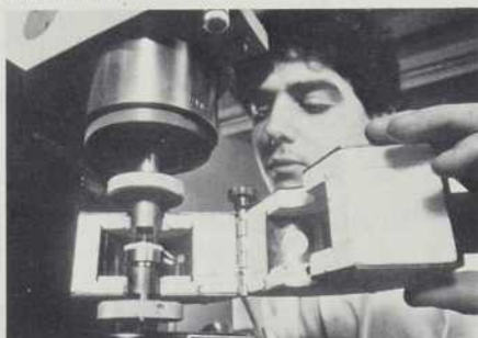
Spectromètre mécanique utilisé pour étudier la propriété visco-élastique d'un polymère solide ou fondu.
