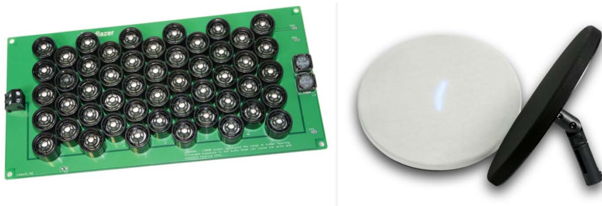
Figure 8. Illustrations des deux HPP commerciaux testés dans l'étude : SoundLazer (à gauche) et Acouspade (à droite).
