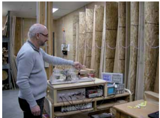
Mesure de la vitesse de propagation d'ultrasons sur un échantillon d'épinette noire en vue d'évaluer le module d'élasticité (MOE) du bois (M. Despons, MRNF)
