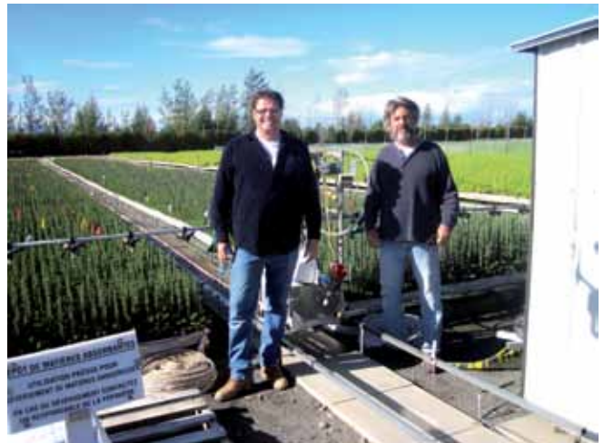
Les prescriptions d'irrigation pour les trois traitements d'irrigation ont été appliquées à l'aide du système informatique IRREC , conçu et mis au point à la DRF (Claude Bérubé, MRNF)
