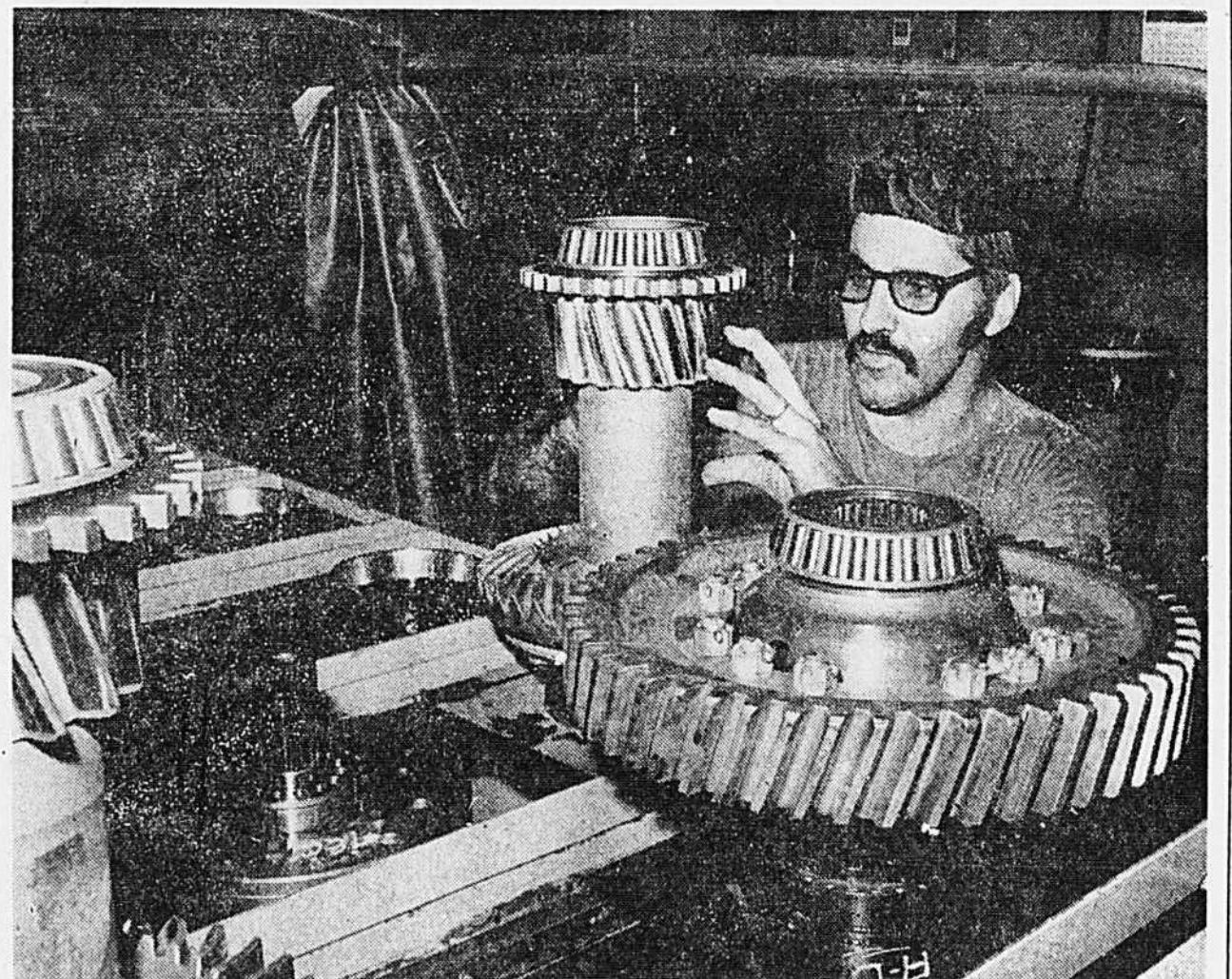
Un mécanicien du service d'entretien des véhicules du métro, M. Pierre Sigouin, au milieu de différentiels en pièces détachées: il nomme chacune d'elles avec une aisance déconcertante. "Le pignon d'attaque qui forme avec la couronne le couple spiroconique, l'arbre intermédiaire, le couple droit, etc."
