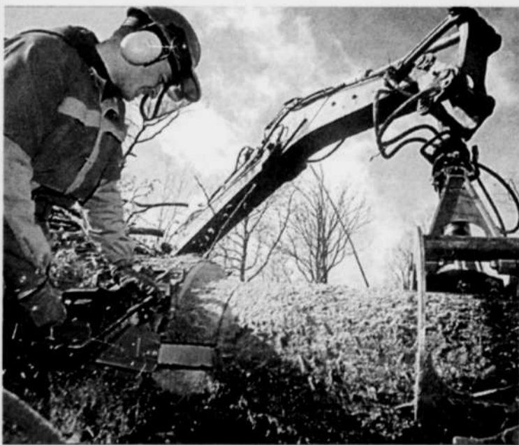
TECHNIQUE - Le travail sur chablis a nécessité la mise en oeuvre de nouvelles méthodes. Munie d'un grappin, la pelleteuse doit intervenir en permanence pour se frayer un chemin, écartier les souches et disposer les troncs afin que le bûcheron Jessy Pronovost de Normandin retrouve une certaine sécurité pour débiter le tronc.
