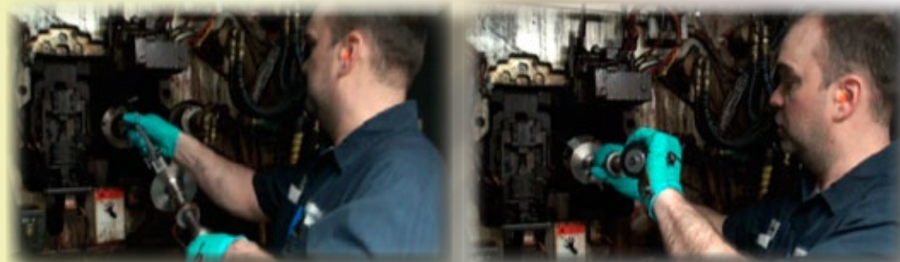
L'extracteur de blanchets permet à l'opérateur de déloger le blanchet cylindrique à partir de son emplacement en quelques minutes.
