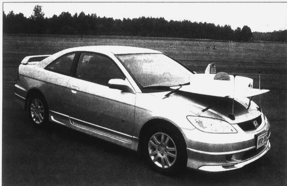
Sur l'un des circuits de PMG, Honda nous a permis de vérifier le comportement routier de l'actuelle Civic en réalisant un test consistant à ne pas laisser s'échapper un ballon logé dans une cuve sur le capot. Inventé par l'ancien pilote de Formule Un Jackie Stewart, cet exercice permet de constater la «grâce» d'une voiture...
