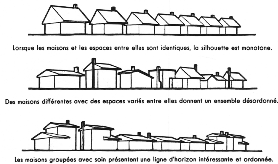
Fig. 5 : Diagramme représentant la normalisation par gabarits et lignes de toiture de Principes pour le groupement de petites maisons . Source : Société canadienne d'hypothèques et de logement (SCHL). Principes pour le groupement de petites maisons , 1954, p. 45. Tous droits réservés. Reproduit avec le consentement de la SCHL. Il est strictement interdit de reproduire ou d'utiliser ce matériel à d'autres fins que celles autorisées.
