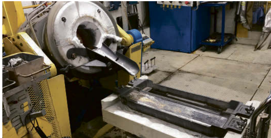
Une première coulée d'alliage d'aluminium-scandium a eu lieu au Centre de recherche et développement d'Arvida (CRDA) de Rio Tinto Alcan. Photo gracieuseté
