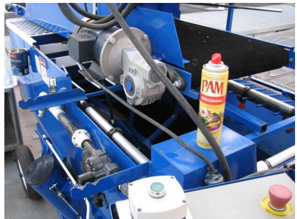
Photo 6 : Remplisseuse nettoyée. Une huile végétale en aérosol est appliquée sur les endroits sujets à la corrosion.
