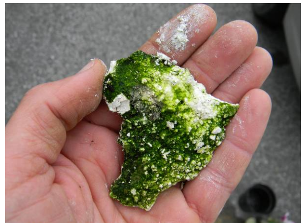
Photo 4 : Plaque de 5 à 6 mm d'épaisseur de chaux hydratée recouverte d'algues provenant d'une zone humide.
